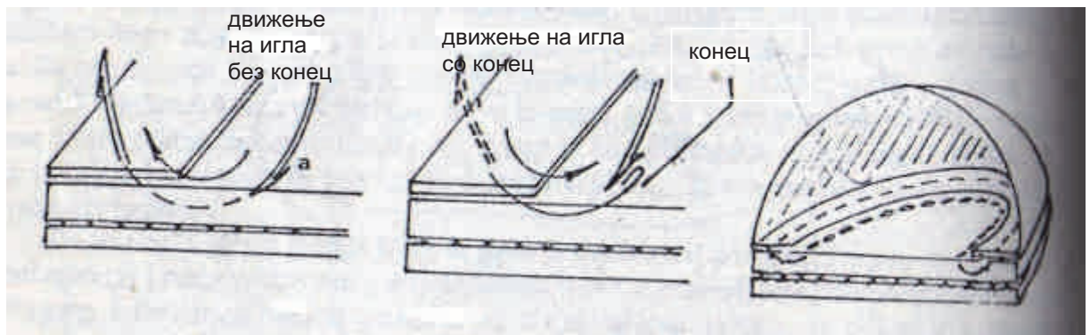
слика 53. Движење на игла при прошивање и изглед на готов производ без покривен табан
